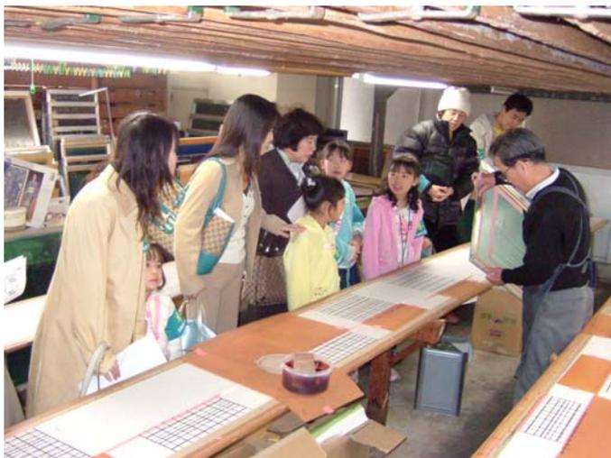
木の板が所狭しと立て掛けられているのが見えます。型染めはこの長い木板の上に生地を張って行うのです。一反の生地が型染めされると、木板を天井のラックに上げて染料が乾燥するのを待ち、その間に次の木板をおろして、違う反物の型
